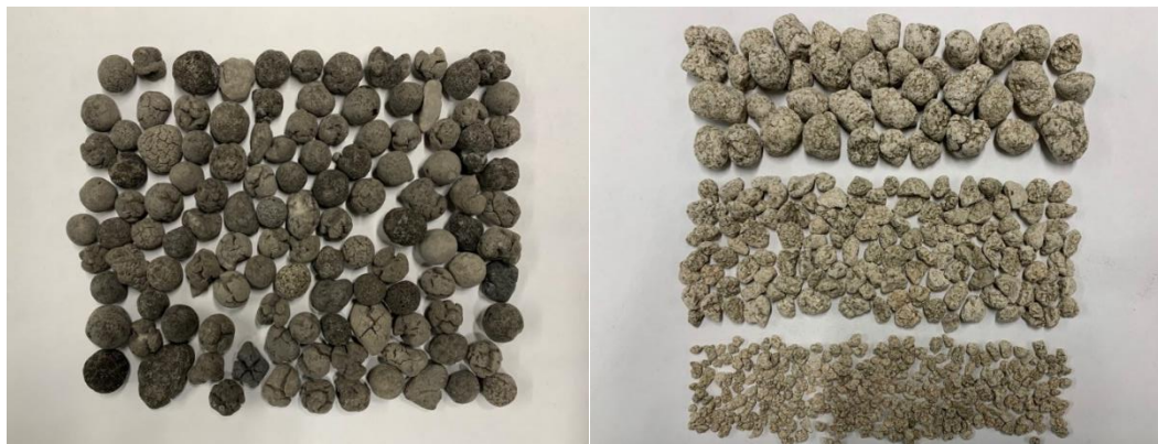
Рисунок 1. Общий вид пористых заполнителей: а – гранулированное пеностекло, б – гранулированный пеноцеолит.
