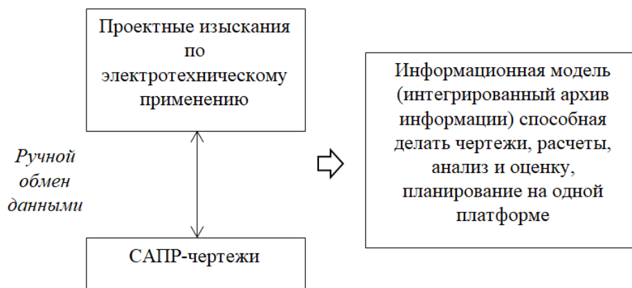
Рис. 1. Разница между традиционным и основанным на BIM-технологии методами проектирования электрической системы
