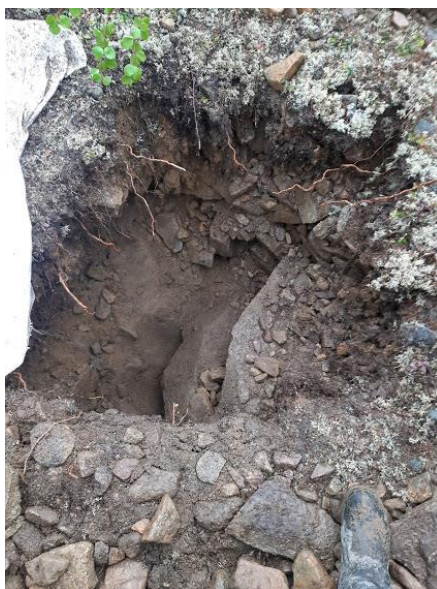
Рис.1. Копуша глубиной и шириной по 1м.
